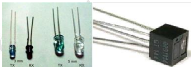
شکل ۱۲- شکل ظاهری چند حسگر مادون قرمز
