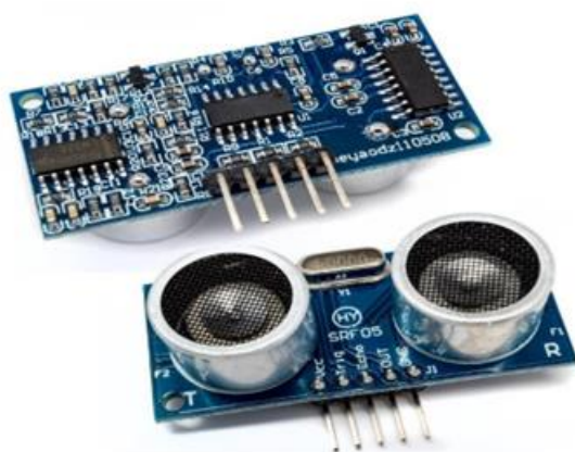
شکل ۱۷- مدار اندازه‌گیری فاصله با حسگر فراصوت (ماژول فراصوت SRF05)
