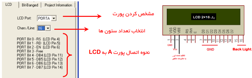
شکل ۸- سربگ LCD و نحوه اتصال LCD
